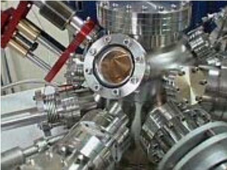
Invention marquante et indispensable aux nanosciences, le microscope à effet Tunnel a été inventé par des chercheurs d'IBM, Gerd Binnig et Heinrich Rohrer, Prix Nobel de Physique de 1986. Outil de haute précision permettant de « voir » les surfaces des matériaux avec une résolution atomique, il peut opérer dans plusieurs conditions extrêmes (pression, température, magnétisme), servir de nano-outil de structuration des surfaces et d'étudier les propriétés électroniques des matériaux.
